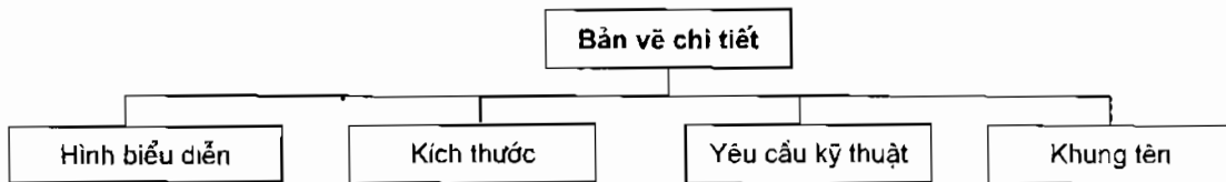
Hình III – 2. Sơ đồ các nội dung của bản vẽ chi tiết
